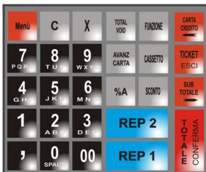
Ad ogni tasto è associato un codice da 0000 a 3000 che individua una determinata funzione. Per alcuni tasti (PAD NUMERICO, C, TOTALE, SUBTOTALE, MENU' e ESCI) non è possibile modificare la configurazione iniziale di fabbrica.
